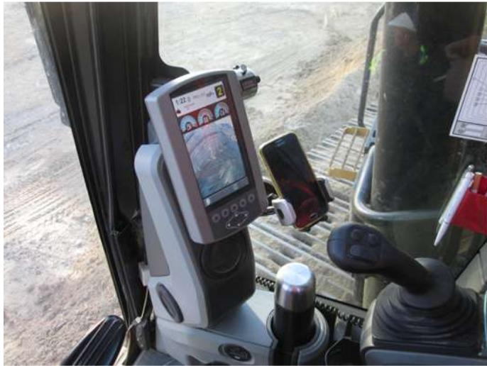
Abb. 3: Kleiner Monitor, nur zeitweise zugeschaltet und gleichzeitig als Statusanzeige für Maschinendaten genutzt
