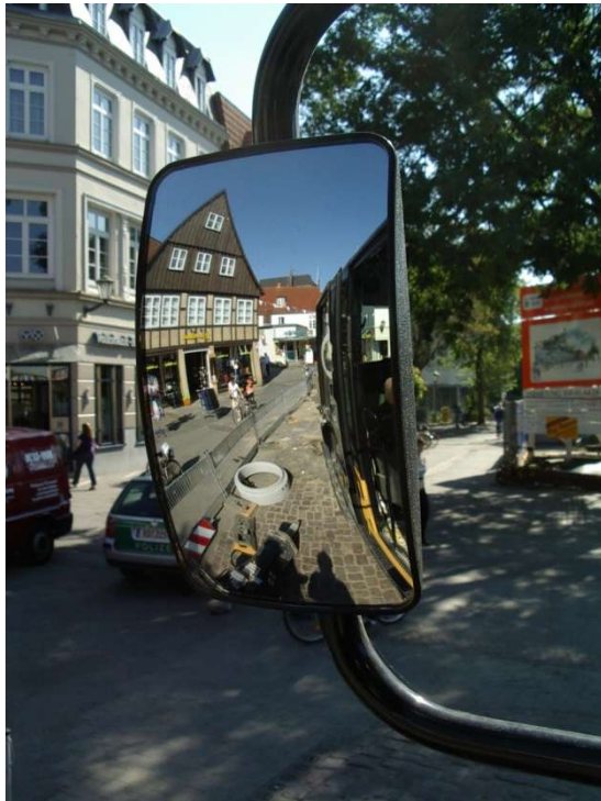
Abb. 1: Der Spiegel vorne links an Baggern ist ein bewährtes und vom Fahrer akzeptiertes Sichthilfsmittel.
